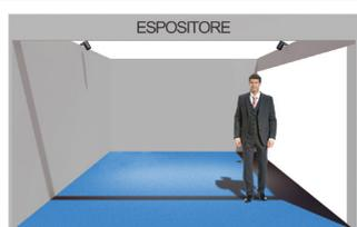
Pareti di separazione h 2,5m; cartellino indicatore con nome dell'espositore, fascione perimetrale, sostenuto da colonne portanti; faretti in misura di 2 ogni modulo di 16m<sup>2</sup>; n. 1 ciabatta elettrica
