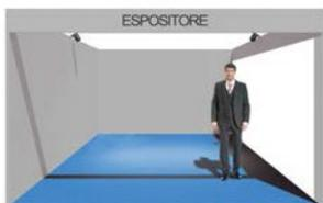
Pareti di separazione in legno tamburato ignifugo h 2,5m, verniciate color crema; cartellino indicatore con nome dell'espositore, moquette ignifuga, fascione perimetrale verniciato color crema, sostenuto da colonne portanti; faretto con lampade in misura di 2 ogni modulo di 16m<sup>2</sup>; n. 1 ciabatta elettrica
